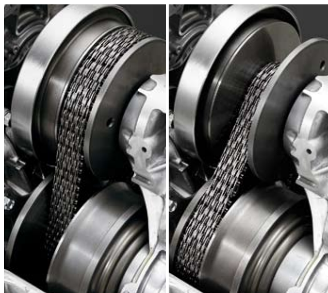
Klíčový prvek nové převodovky CVT: lamelové řetězy. Bezprodlevové změny převodových stupňů v podstatě nepostřehnete
