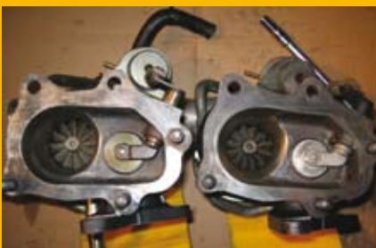
Díky využívání energie výfukových plynů je turbodmychadlo jednou z nejvíce teplotně namáhaných součástí motoru
