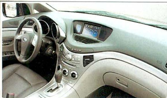
**Tubusovité přístroje s optitronovým podsvícením působí luxusně a perfektně se čtou**
