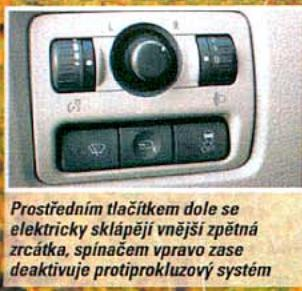
Prostředním tlačítkem dole se elektricky sklápí vnitřní zpětná zrcátka, spínačem vpravo zase deaktivuje protiprokluzový systém
