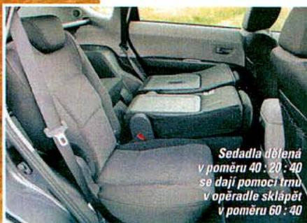
Sedadla dělená v poměru 40 : 20 : 40 se dají pomocí trnu v opěradle skládat v poměru 60 : 40
