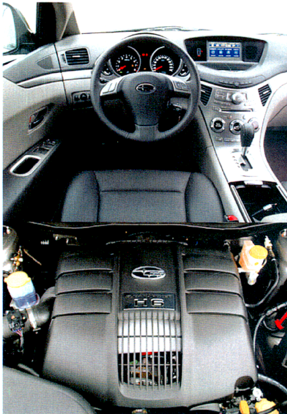
Pod přední kapotou největšího modelu japonské značky Subaru se ukrývá třilitrový šestiválec o výkonu 245 koní
