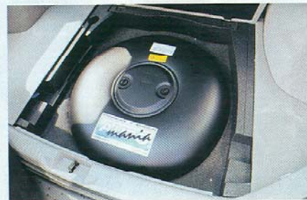
Zásobník plynu je uložen na místě rezervního kola
