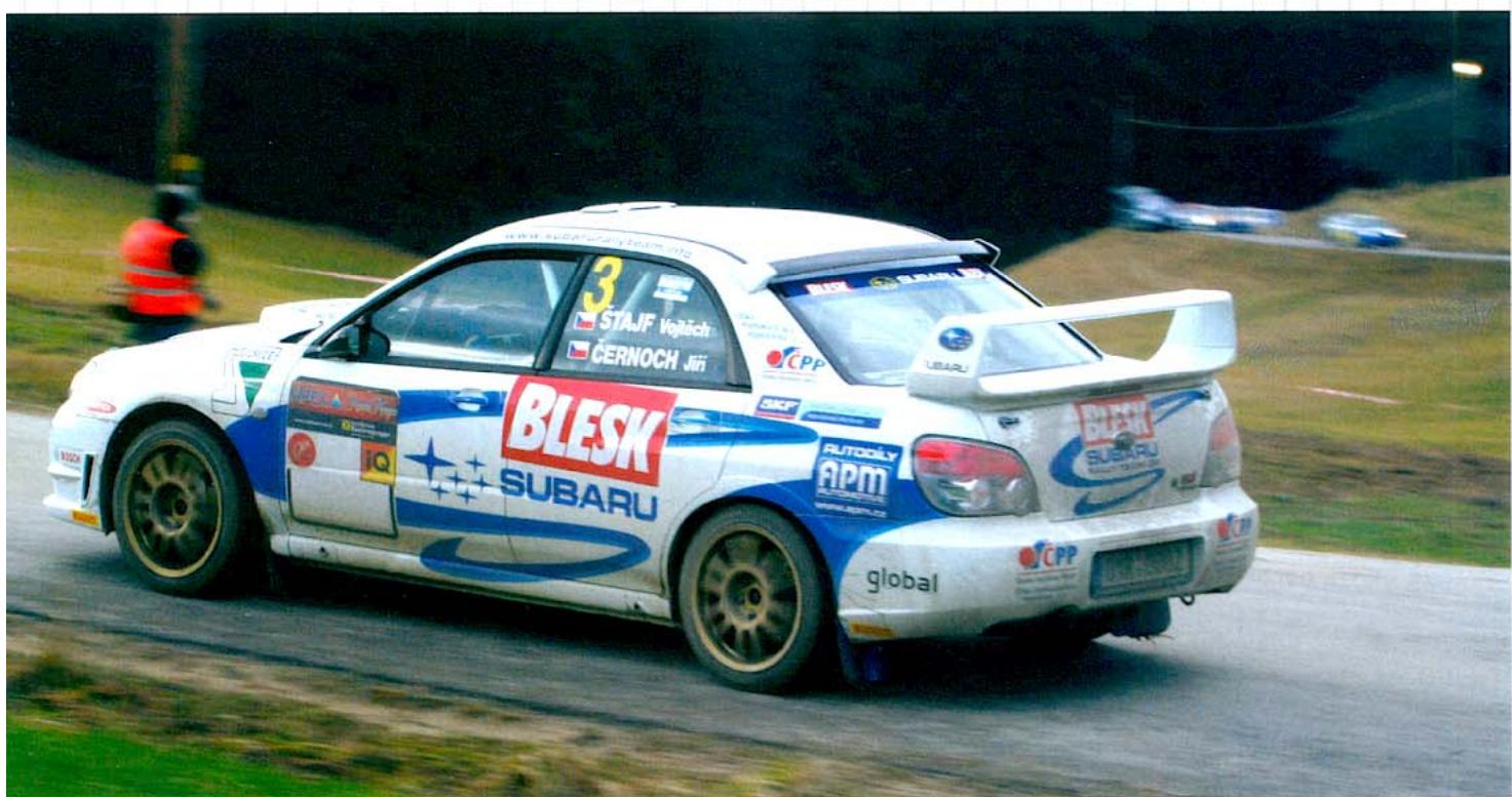
logo Subaru Tecnica International. Další výraznou změnou proti předešlé generaci je malý střešní spoiler nad zadním oknem usměrňující proud vzduchu před rovněž nové zadní křídlo. Bavíme-li se o aerodynamice, je třeba zmínit difuzor pod zadním nárazníkem zlepšující proudění pod vozem. Vezmeme-li v úvahu ještě další drobné vnější úpravy, jako je nižší násos chladícího vzduchu mezichladiče, jiné zadní lampy apod., můžeme výčet externích změn ukončit.
