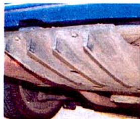
Zadní difuzor usměrňuje proudění vzduchu pod vozem Foto P. HOMOLKA
