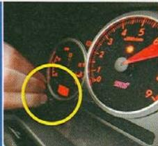
Otočným ovladačem na palubní desce si můžete sami nastavit hodnotu otáček, při nichž vás má signál upozornit na blížící se nutnost přezáření.
