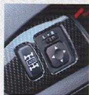
Aktivní mezinápravový diferenciál je klíčem k úspěchu. Impreza ho má nastavitelný v pěti polohách, Evo ve třech. U Eva navíc najdete elektronický systém řízení boční stability.
