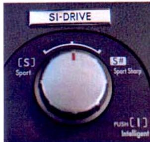
Navolením jednoho ze tří režimů systému SI-Drive se mění odezva škrťicí klapky na pohyb pedálu plynu, a tím i reakce motoru.
