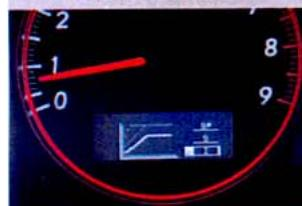
V rychloměru se nově objevil ekonoměr, v otáčkoměru přibyl multifunkční displej. Kromě údajů palubního počítače se v něm zobrazuje navolený režim SI-Drivu.
