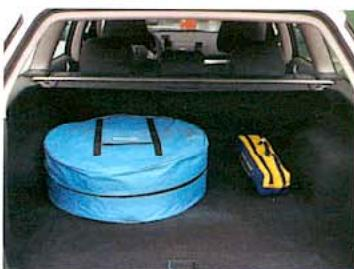
Toroidní nádrž na LPG vystranila rezervu (nahore). Pokud ji chcete nechat doma, požádejte dealera o montáž senzoru tlaku (detail) a sadu na lepení pneumatik.
