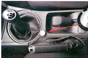
Vedle řadicí páky pětistupňové převodovky najdete na tunelu ještě volič redukce a přepínač LPG s ukazatelem stavu plynu v nádrži (ve výrezu).
