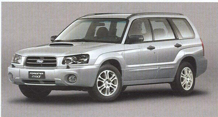
podpořena sportovně laděným podvozkem Bilstein a osmnáctipalcovými koly s obutím 215/45 R 18.
