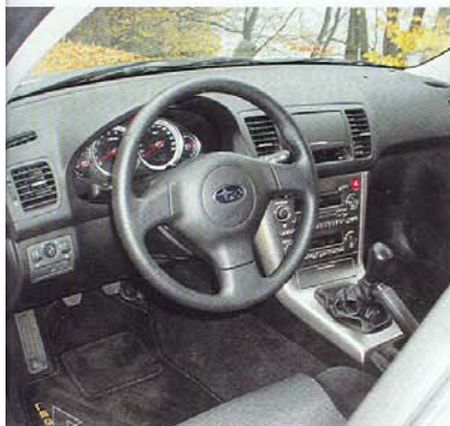
Volant je seřiditelný pouze v jednom směru
