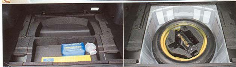
Pod podlahou zavazadlového prostoru se ukrývá vyjímatelná přihrádka na drobnosti a teprve pod ní je uložena rezerva
