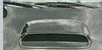
Na první pohled poznáte vznětové Legacy podle výrazného vstupu vzduchu k mezichladiči turba
