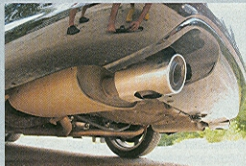
Lišácké řešení – výfuky dieselu vypadají jako otevřené koncovky, skutečné zakončení ale směřuje dolů
