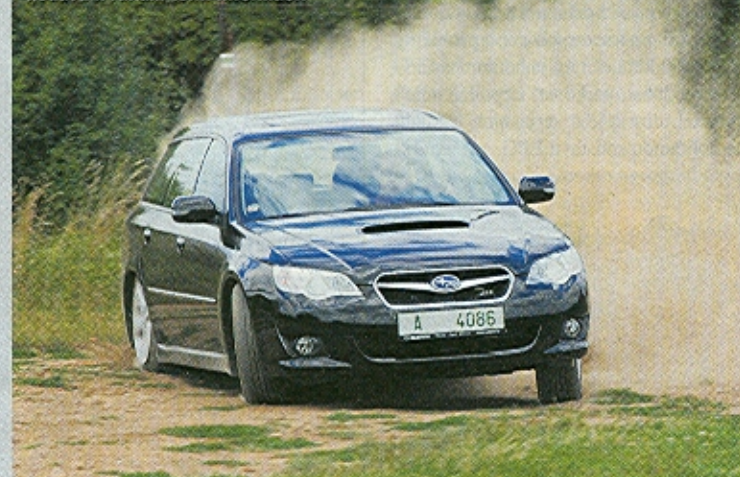
Na první pohled poznáte vznětové Legacy podle výrazného vstupu vzduchu k mezichladiči turba
