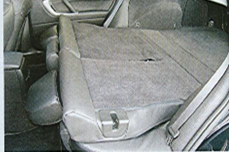
Vnější místa zadního sedadla lze oddělit sklopnou loketní opěrou; po sklopení opěradel lze prodloužit délku zavazadlového prostoru na nejméně 1800 mm
