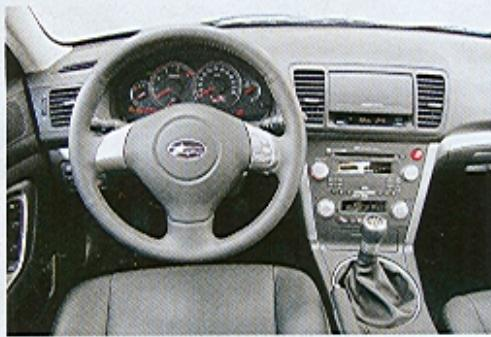
Přístrojová deska i dvousměrně seřiditelný volant s tlačítky tempomat na pravém rameni jsou shodné; Diesel prozrazuje jen otáčkoměr s červeným polem od 4750 min<sup>-1</sup>.
