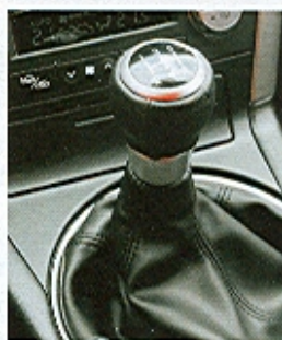
Řadicí páka má přesnou a příjemně tuhou kulisu. Proti zážehovým verzím se zkrátila o 10 mm.
