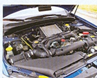
▲ 2,5litrový přeplňovaný boxer má nové variabilní časování zdvihu ventilů
