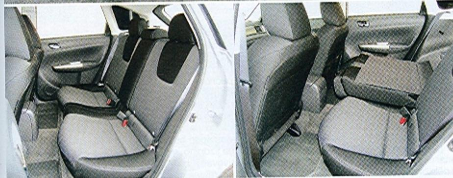
**Zadní sedadlo má bezpečnostní pásy i opěrky hlav pro tři cestující, náznakově anatomicky tvarovaná jsou však jen vnější místa; nesouměrně dělená opěradla jsou sklopna na sedáky**
