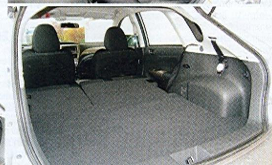
▲ Sklopením zadních opěradel se ložná délka zavazadlového prostoru zvětší téměř dvojnásobně
