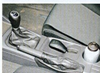
▲ Za řadicí pákou je vedle páky ruční brzdy ovládání dvoustupňové redukční převodovky
