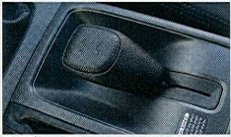
POMOCÍ dvoustupňové manuální redukce můžete změnit převodový poměr do pomala.
