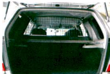
Pro verzi N1 je k dispozici posuvná dělicí přepážka s otvorem pro přepravu dlouhých předmětů
