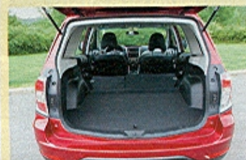
Vyšší podlaha zavazadelníku je daná za použití plnohodnotné rezervy
