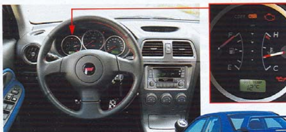
Mezi ukazatelem teploty chladicí kapaliny a stavu paliva najdeme šipky indikující nastavení aktivního diferenciálu
