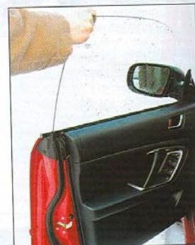
Dveře mají bezrámovou konstrukci a při jejich zavírání se vyplatí nesať na skla jako na snímku - kvůli vycentrování
