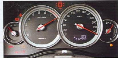
Před spuštěním motoru si všechny ukazatele cvičně „projedou“ své pracovní pole
