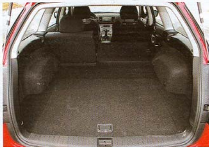
Zavazadelník má nakládací hranu v rovině s podlahou, po sklopení opěradel nevzniká schod
