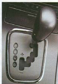
Pro 2,0 l se dodává čtyřstupeňový automat, pro 3,0 l pětistupňový. U obou nechybí ruční řazení.
