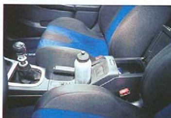
Anatomická přední skořepinová sedadla mají vysoká opěradla s integrovanými opěrkami hlav, řidičovo je ve velkém rozsahu seřiditelné i svisle. V konzole mezi nimi je odkládací schránka a před ní dutina pro nádobku s nápoji a spinač seřizování vnitřních zpětných zrcátek.
