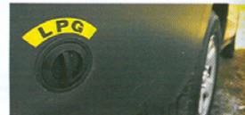
Ventil pro čerpání plynu se nachází vzadu v nárazníku
