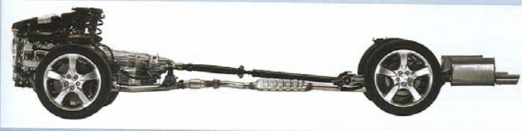
Symetrický pohon všech kol s plochým motorem „boxer“ zajišťuje u vozů Subaru nejnižší těžiště
