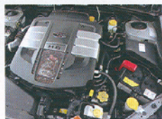
Plochý šestiválec o objemu rovné 3 litry poskytuje legacy ve střední třídě nadprůměrnou jízdní dynamiku.
