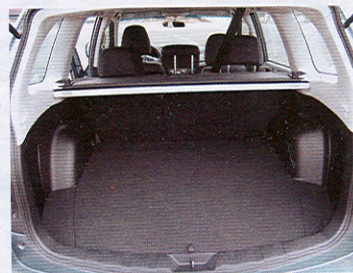
Kvůli umístění zadního diferenciálu pod podlahou a rezervnímu kolu je zavazadelník dost mělký
