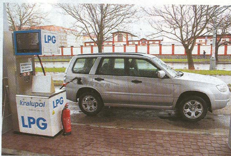
Tankovací pistole pro doplňování nádrže LPG se podstatně liší od benzinové či naftové a navíc ji může obsluhovat pouze kvalifikovaný pracovník čerpací stanice
