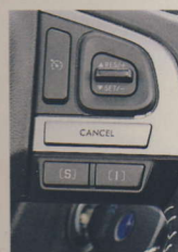
Tlačítka S (Sport) a I (Intelligent) lze volit provozní režim motoru a převodovky
