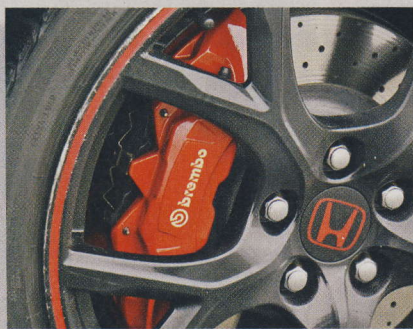
Brzdy Brembo si za několik tisíc km užily své a při práci pískaly
