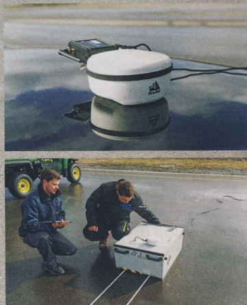
GPS anténa na střeše přenáší údaje o rychlosti testovaného vozu.
