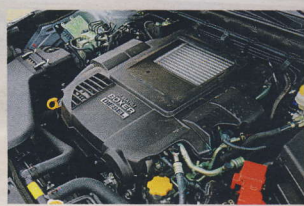
Boxer diesel nově díky přepracovanému turbu splňuje emisní normu Euro 6.
