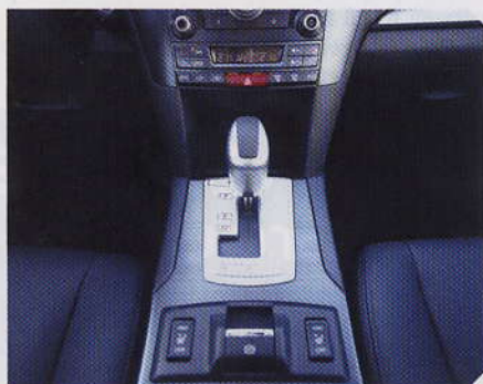
Při ostřejší jízdě Lineartronic pracuje s předvolenými převodovými stupni.
