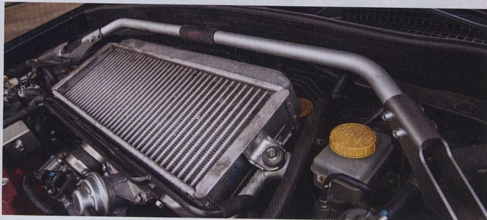
▲ MEZICHLADIČ STLAČENÉHO VZDUCHU ZÁSOBUJE TURBO STUDENÝM VZDUCHEM. PŘI MAXIMÁLNÍM VYUŽÍVÁNÍ NA OKRUHU JEJ MUSÍTE PŘESUNOUT DO PŘEDNÍHO NÁRAZNIKU.
