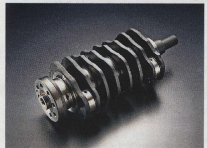
▲ Klikový hřídel je pětikrát uložen a využívá osm protizávaží.
