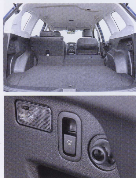
Sklopení opěradel je nyní jednodušší. Stačí v zavazadlovém prostoru stisknout ovladač. Vznikne téměř rovná ložná plocha. Objem narostl o 55l.
