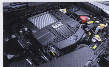
Novinkou je přeplňovaný zážehový boxer 2.0/177 kW. Mezichladič stlačeného vzduchu zůstal mezi válci, kapota se však obešla bez otvoru pro sání.
