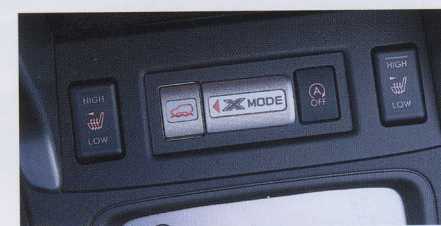
Režim „X-Mode“ bude standardně k dispozici pro výbavy Premium a XT se samočinnou převodovkou Lineartronic. Umožňuje i bezpečnější pohyb v náročnějším terénu.
