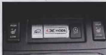
Elektronický závěr diferenciálu X mode s nastavitelnými režimy zlepšuje průchodnost terénem
