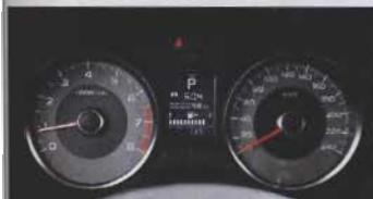
Počítací kruhové přístroje kontrastují s proměnlivou přehledností informačních displejů. Teploměr vody chybí.
