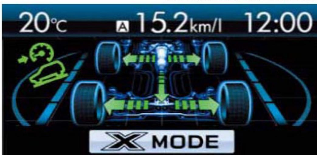
Jaké funkce systém X-Mode pro zvládnutí složitějších jízdních podmínek aktuálně využívá, se řidiči zobrazuje na multifunkčním displeji.
