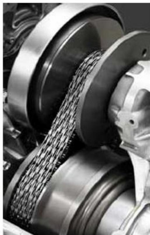
Princip plynulé změny převodového poměru prostřednictvím variátoru (CVT)
