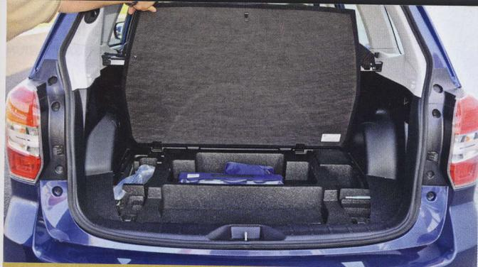
Zadní, elektricky vyklápěné dveře dobře zpřístupňují zavazadlový prostor s vyšší nakládací hranou, nabízející v základním uspořádání slušný objem 0,488 m<sup>3</sup>
