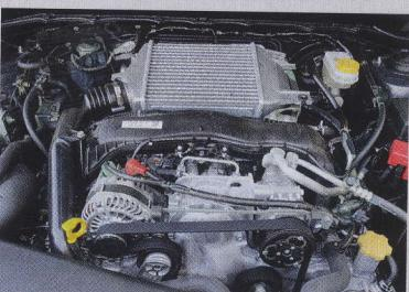
**Dieselový boxer běží bez vibrací a byl by nesmírně silný. Mezichladič nahoře a kapota bez průduchu jej však zabíjejí.**
