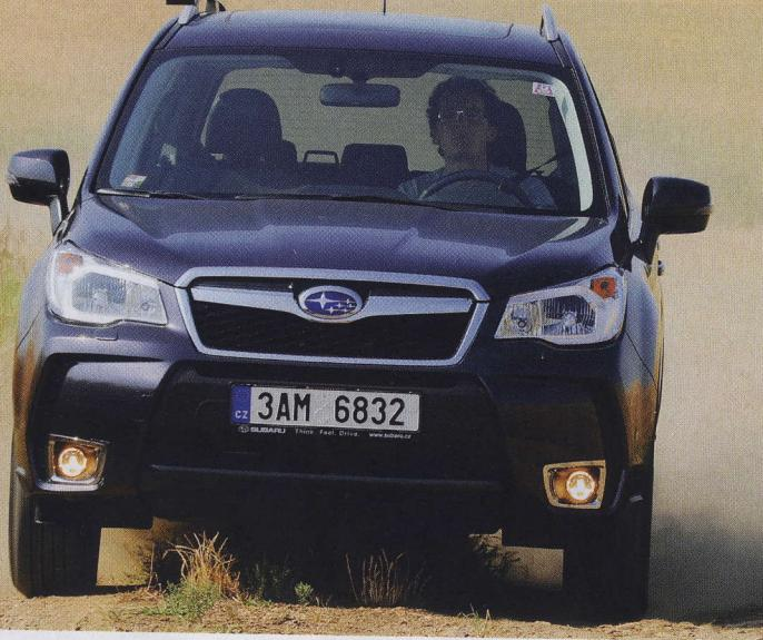
**V**e čtvrté generaci foresteru zmizel charakteristický průduch na kapotě, dle kterého jste poznali přeplňované varianta (včetně dieselu). Mohou za to požadavky na bezpečnost sražených chodců, jimž vyhovuje pouze hladká kapota bez výstupků. A je to pořádná škoda, hned ze dvou důvodů:
