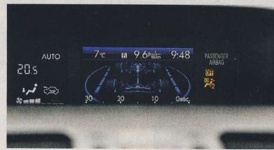
▲ Multifunkční displej umí zobrazovat až překvapivě mnoho údajů. Například okamžitě rozdělení hnací síly mezi nápravu i kola.
