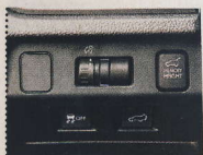
▲ Elektricky ovládané víko zavazadelníku má dokonce programovatelnou míru otevření. ESP (tady VDC) lze vypnout.
