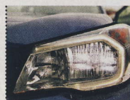
▲ Pouze základní verze Active má na tomto místě halogenové žárovky. Zbytek sází na xenonové výbojky (HID).
