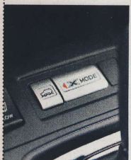
▲ Systém „X-Mode“ je novinkou, umožňující mimo jiné i snadnější sjíždění prudkých svahů.
