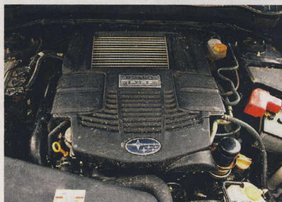
▲ Motor FA20 je absolutní novinkou a pří- náší kombinaci „turbo/přímý vstřík“.
