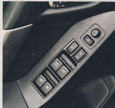
▲ Pouze řidičovo okno lze zcela otevřít či zavřít pouhým jedním stiskem tlačítka.
