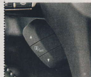
▲ Ovládání multifunkčního displeje se nachází přímo na volantu.
