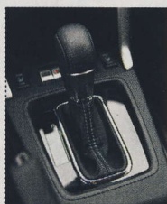
▲ Volič převodovky Lineartronic. V nabídce je i 6, resp. 8 předvolebných převodů.
