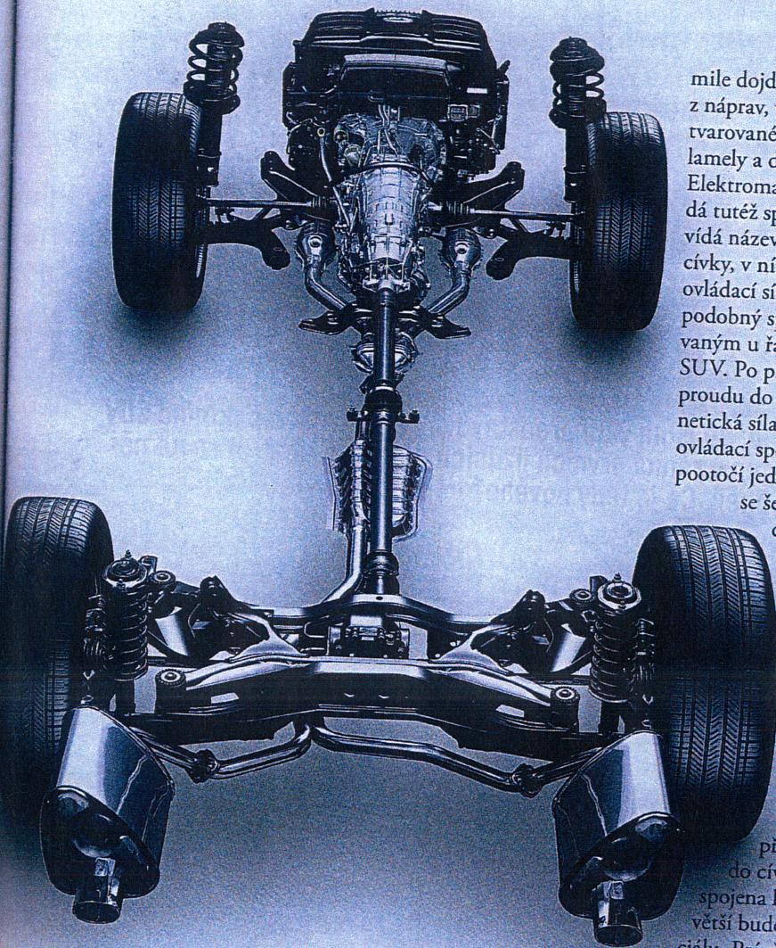
pouze slova chvály. Za precizními jízdními vlastnostmi stojí samosvorný diferenciál jak na přední, tak na zadní nápravě a systém DCCD (Driver Controlled Center Differential). Jeho základem je opět planetový diferenciál (obrázek 3), opět se spojkou ovlivňující jeho svor-
