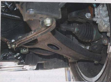
Pod předním rámennem je malá rozpěra, která zároveň chrání silentblok před poškozením
