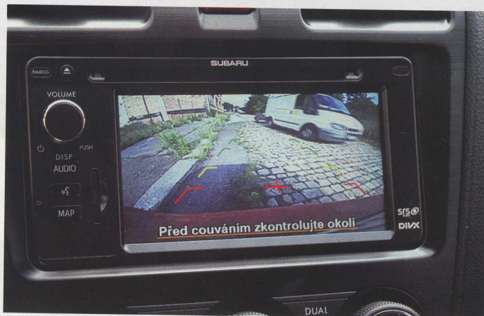
Zadní kamera přijde vhod při parkování, jinak se v tomto přístroji skrývá ještě audiosouprava a navigační systém
