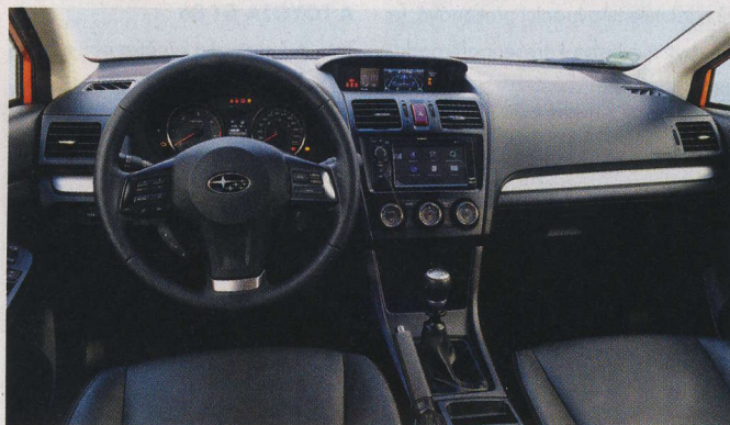
Součástí přístrojové desky je také multifunkční displej, mající ve vyšších stupních výbavy podobu barevného LCD s rozšířenou funkcí
