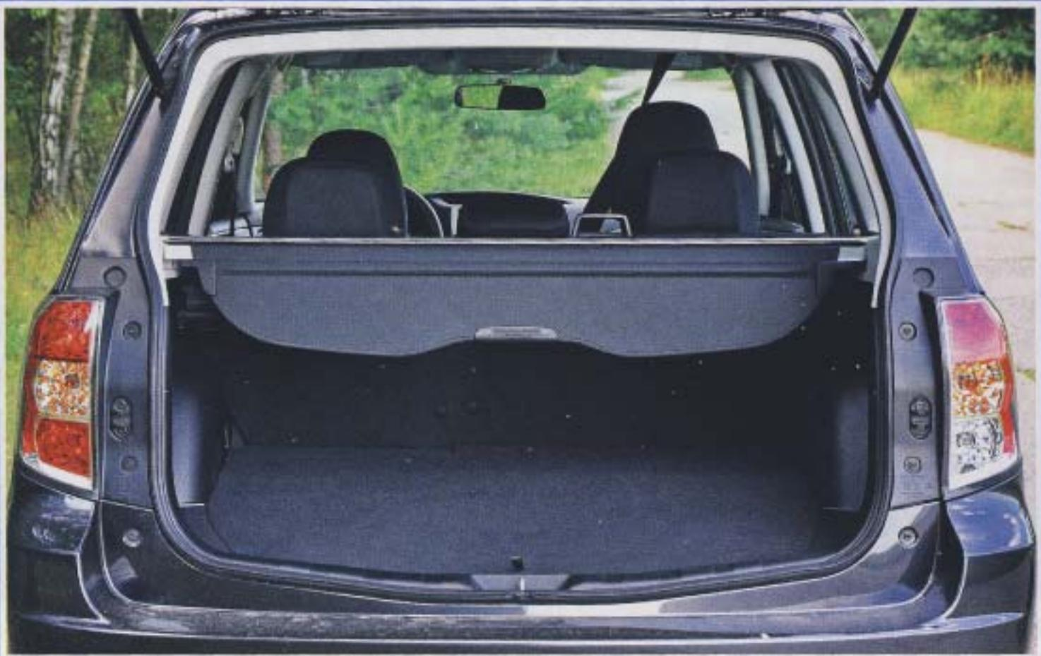
Forester je veľmi praktické SUV. Zavazadelník nabídne minimálne dostatečných 460 l. Zadní opěradla se skládají pomocí páček umístěných po stranách zavazadelníku
