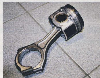
▲ Asymetrické ojnice pro snazší montáž mají oka dělená lomem.
