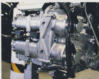
▲ Záběr na dvojici variátoru s ovládacími ventily OCV systému AVCS.
